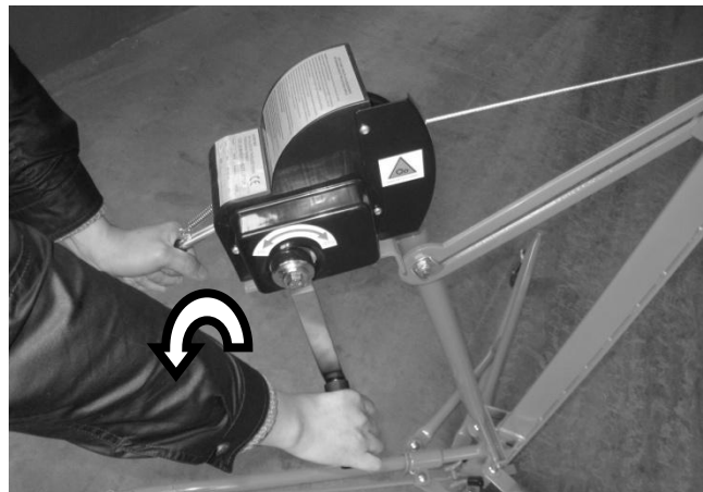
Obr. 6. Zľahka otáčajte pákou navijaka smerom dozadu (proti vám), kým nezapadne zaisťovacia podložka do drážky klznej tyče.
