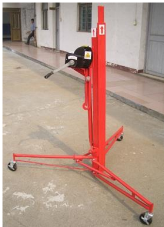
Obr. 5. Akonáhle je hlavný stojan na základni správne usadený, uvoľnite zarážku (viď. obr. 2. obrátene).
