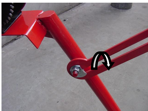
Obr. 7. Uistite sa, že je zaisťovacia podložka uchytená v mieste na konci klznej tyče.
