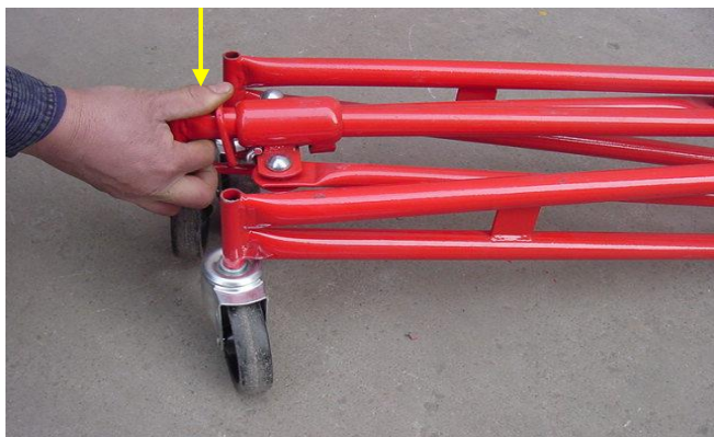
Obr. 1. Začnite nastavením 3-ramennej základne: Zatlačte smerom nadol na kotviace krúžok a rozťahnite ramená základne pokiaľ nebudete počuť zacvaknutie – v pracovnej polohe (otvory v spodnej strane posuvné rúrky).
