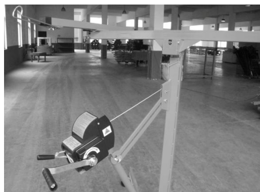
Obr. 8. Na hornú časť teleskopической časti stojana upevnite naklápacie rameno. Vtiahnite poistku, aby bolo možné naklopiť rameno do požadovaného uhla pre naloženie sadrokartónového panelu a jeho zavesenie na strop alebo bočné steny.
