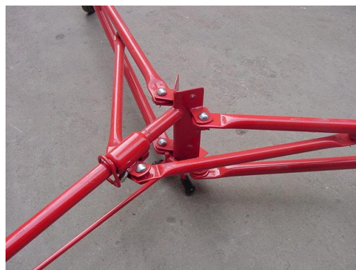
Obr. 4. Uistite sa, že je uhol hlavného stojana v rovnakom uhle ako uhol na základni.
